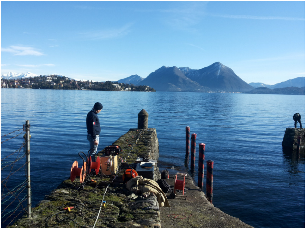
Geofoni da 14Hz montati su land streamers utilizzati nella parte fuori acqua.
