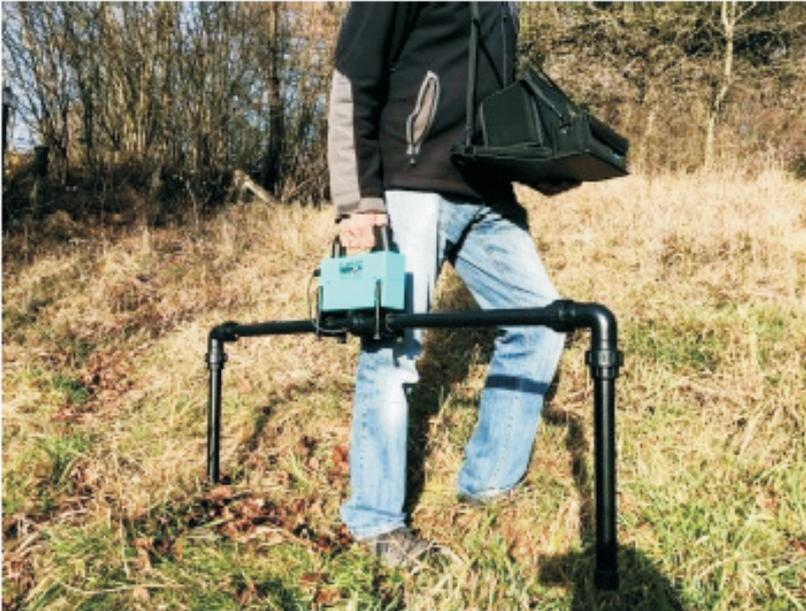
E' stata eseguita un'indagine geofisica mediante elettromagnetometro VLF.
